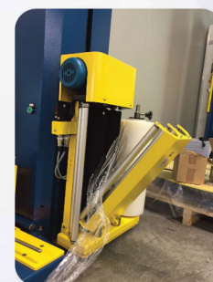
CARRELLO PORTA BOBINA con PRESTIRO 200% e TENSIONAMENTO FISSO
